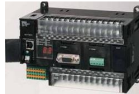
Omron C/CV/CS/CJ/CP 系列 HostLink 9 针 D 形公头
